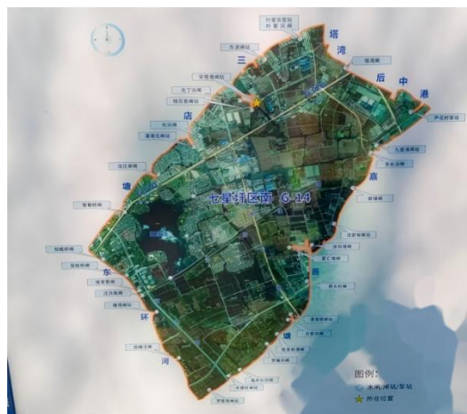
图 3.3-1 七星圩区水闸、泵站分布图
